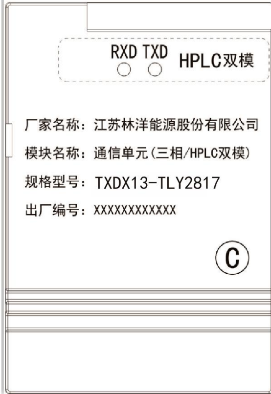
图 2-1 三相模块外观示意图
